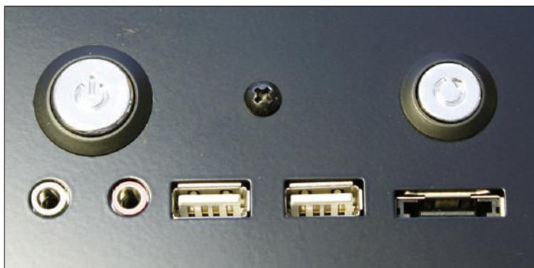
Slika 4. 3 - Prednja strana kućišta s tipkama za uključivanje, reset i priključima za vanjske uređaje
