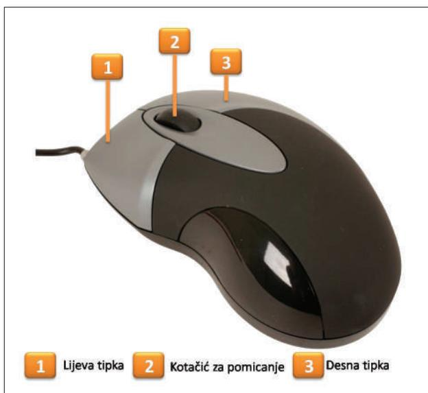
Slika 4. 8 - Dijelovi miša
